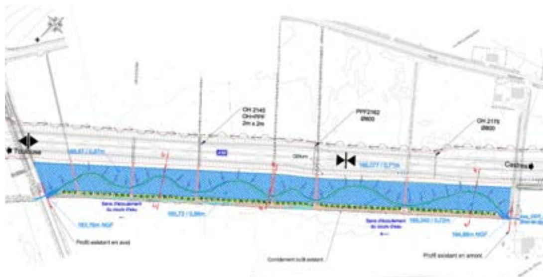
Illustration 334. Schéma du rescindement du Messal/Bras mort du Girou
