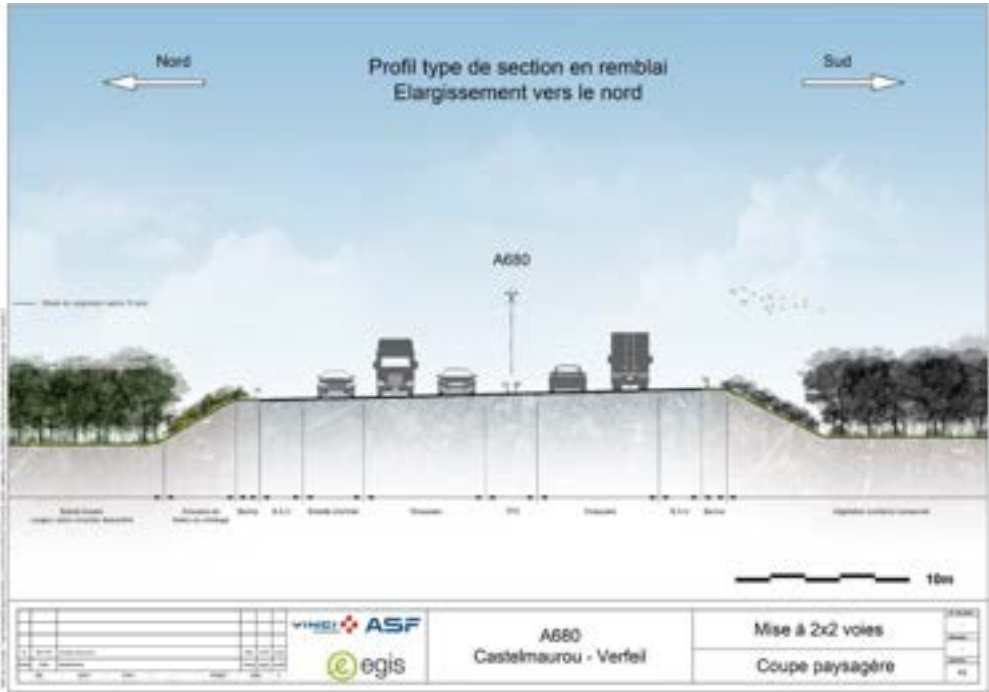
Illustration 300. Profil type de section en remblai - Élargissement vers le nord (source : egis)
