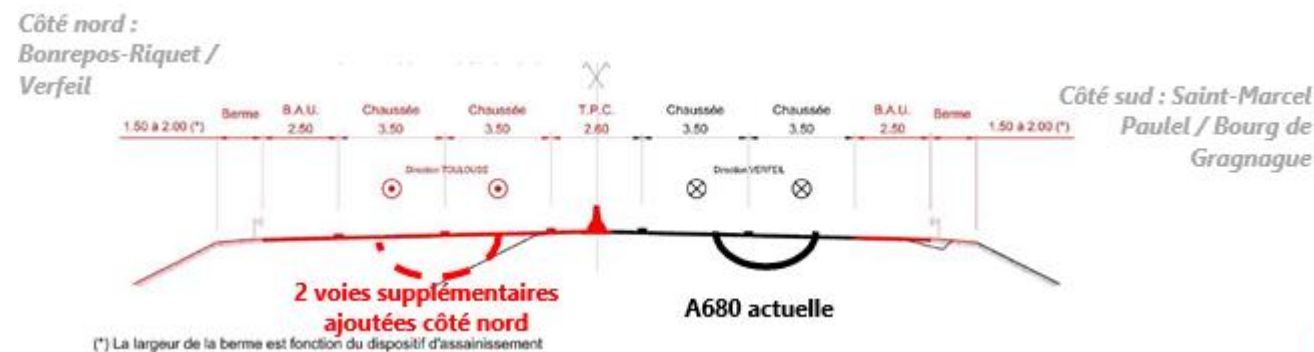
Illustration 1. Profil en travers type de l'A680
