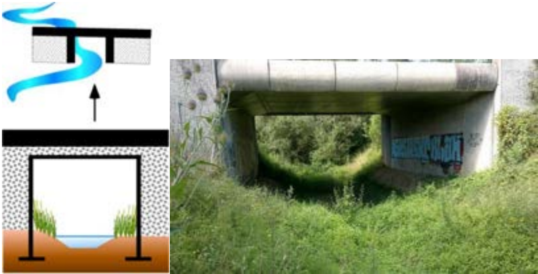
Illustration 311. Principe d'implantation d'ouvrage (ou portique) ouvert : pas de modification du lit mineur, fond et berges « naturels », pas de dérivation provisoire en phase travaux (Source : Cerema,2013)
