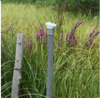
Piezomètre avec sonde (MhéO, 2021)
