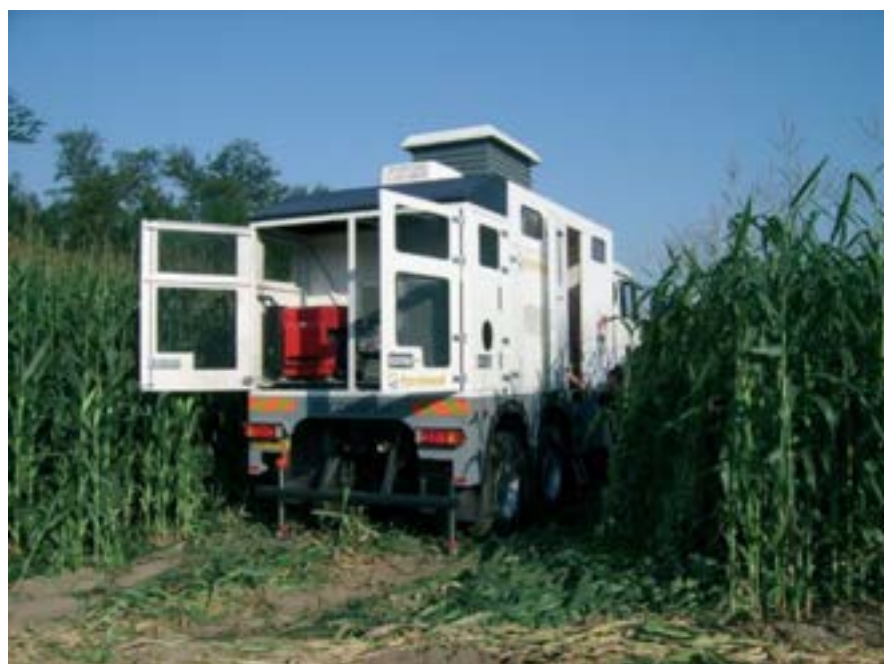
Illustration 16. Exemple sondage géotechnique avec pénétromètre statique (Source : Fondasol)
